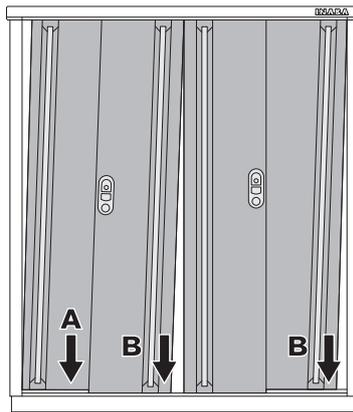
※3mm以上のスキマや上記の要領で調整できない時は、目隠しキャップをはずしベースの水平を出し直してください。(「2.ベース設置」を参照)
