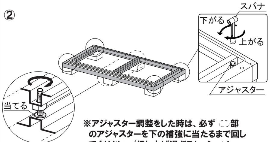
※アジャスター調整をした時は、必ず○部のアジャスターを下の補強に当たるまで回してください。(但し上げ過ぎると、シーソーのようになりますので注意してください。)
