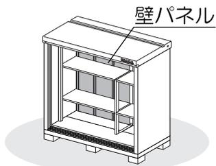
①壁パネルを側板後ろにはめ込み、縦方向(a)をボルトとパッキン付ネジ板で取り付け、横方向(b)をボルトとネジ板で取り付けます。
